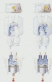
Das YAMAHA-Duo-Intake-System (YDIS) ist ein aus zwei Vergasern bestehendes Einlaßsystem, das für einen optimalen Gasdurchsatz und damit einen äußerst wirksamen Ablauf des Verbrennungstaktes sorgt. Hierbei ist Vergaser Nr. 1 für die Gemischaufbereitung bei niedrigen Drehzahlen zuständig, Vergaser Nr. 2 liefert das für die Erzielung der Höchstleistung erforderliche zusätzliche Gemisch.
