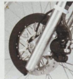
Auch für Off-Road-Maschinen setzt sich die Verwendung von Scheibenbremsen immer mehr durch. Diesem sinnvollen Trend folgend, wurde auch die neue XT350 mit einer Scheibenbremse am Vorderrad ausgerüstet. Eine Aluminiumbremszange und sintermetallische Bremsklötze liefern hervorragende Verzögerungswerte. Der Durchmesser der Bremscheibe beträgt 245 mm. Ein Kunststoffschild schützt vor Schmutz und Beschädigungen.
