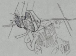
Lufthutzen links und rechts am Tank führen dem 4-Ventil-Zylinderkopf ausreichend Kühlluft zu. Die elektronische Zündung besitzt eine automatische Zündverstellung und ist außerdem wartungsfrei.
